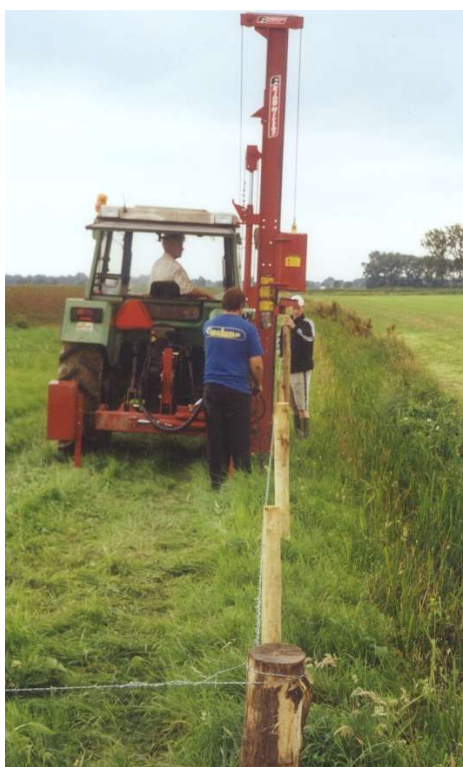
foto: Met de Kinghitter een puntdraadraster plaatsen
